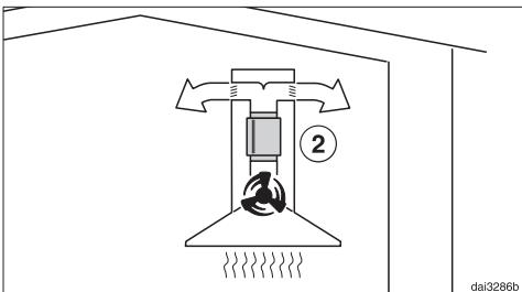
Στη λειτουργία ανακύκλωσης αέρα ο σιγαστήρας τοποθετείται ανάμεσα στο στόμιο εξαγωγής αέρα και τον οδηγό εκτροπής (2). Ελέγχετε τον χώρο τοποθέτησης.
