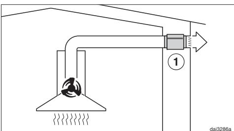
Κατά τη λειτουργία εξαγωγής του αέρα ο σιγαστήρας εξασθενίζει τόσο τους θορύβους της τουρμπίνας μεταφέροντάς τους προς τα έξω, καθώς και τους εξωτερικούς θορύβους οι οποίοι εισέρχονται μέσω του αγωγού εξαγωγής αέρα στην κουζίνα (π.χ. θόρυβοι από τον δρόμο). Για αυτόν τον λόγο, ο σιγαστήρας τοποθετείται όσο το δυνατόν πιο κοντά στο σημείο εξαγωγής του αέρα (1).
