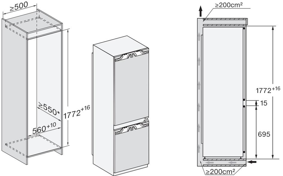
\* La consommation énergétique déclarée a été déterminée à partir d'une profondeur de niche de 560 mm. Avec une profondeur de niche de 550 mm, l'appareil fonctionne parfaitement mais consomme légèrement plus d'énergie.
