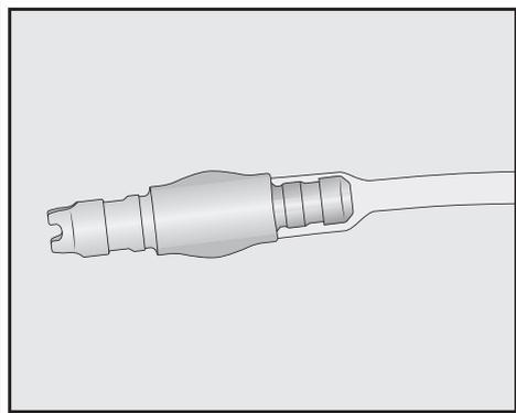
Si vous avez détaché le raccord du conduit de lait : lors de l'assemblage, assurez-vous que le côté le plus petit et le plus fin du raccord est bien enfoncé dans le tuyau.
