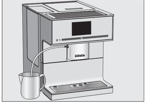
■ Posez le récipient près de la machine à café puis accrochez le conduit de lait dans la solution de nettoyage. Vérifiez que le conduit de lait est suffisamment enfoncé dans la solution de nettoyage.
