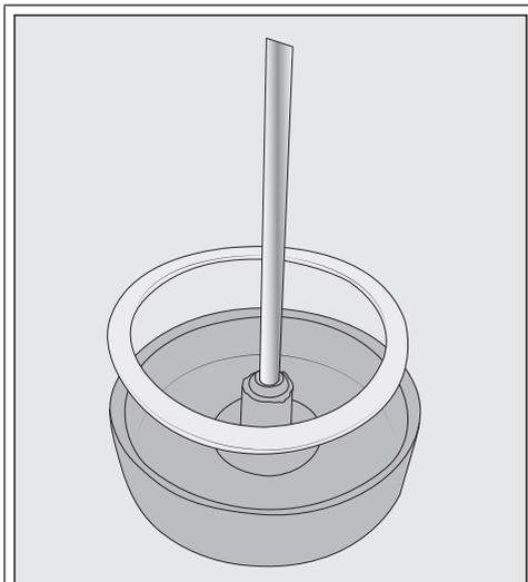
Si nécessaire, vous pouvez retirer la pièce de raccordement et la bague d'étanchéité du couvercle du récipient à lait. Après avoir retiré le tuyau en inox, vous pouvez extraire facilement la pièce de raccordement par la face interne du couvercle.
