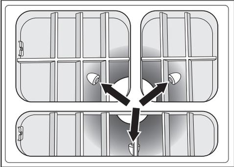
El diagrama muestra tres depósitos de café, uno encima de los otros. Cada depósito tiene un sensor de nivel en su interior. Flechas blancas apuntan desde los sensores hacia el exterior, indicando que deben ser limpiados. Una flecha negra apunta hacia abajo desde el sensor del depósito inferior.</div> <ul style="list-style-type: none"><li>■ Limpie los sensores de nivel (ver imagen) con un paño suave y seco.</li></ul> |
