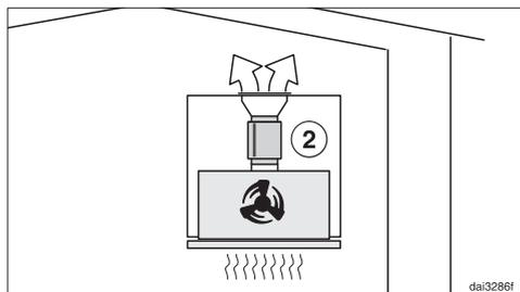
Con il funzionamento a ricircolo posizionare il silenziatore tra il bocchettone di evacuazione aria e la griglia. Controllare lo spazio di montaggio.
