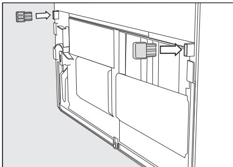
■ Смонтируйте проставки на задней стороне прибора внизу слева и внизу справа.
