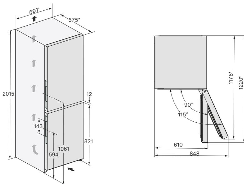
\* Dimensões sem distanciadores de parede montados. Se os distanciadores de parede fornecidos na embalagem forem utilizados, a profundidade do aparelho aumenta cerca de 15 mm.
