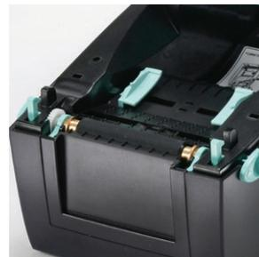
Ein einstellbarer Sensor ermöglicht auch das Drucken von kleinen und schwierigen Etiketten
