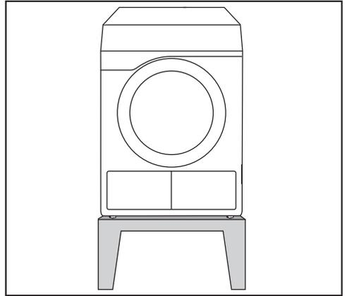
Socle en acier\* (bases ouvertes ou fermées, p.ex., APCL 002, APCL 003, APCL 005, APCL 007, APCL 011 or APCL 012)
