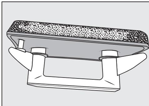
Les résidus proviennent des fibres textiles et des traces des composants de détergent, qui peuvent obstruer le filtre. Ils sont visibles sur les bords avant et latéraux du filtre. Dans certains cas extrêmes, ils peuvent former des dépôts incrustés.
