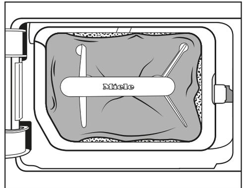
Les bords du filtre ne sont pas alignés et le filtre est déformé. Les peluches non filtrées vont pénétrer dans l'échangeur thermique par ces côtés non alignés. L'échangeur thermique sera alors obstrué en permanence.
