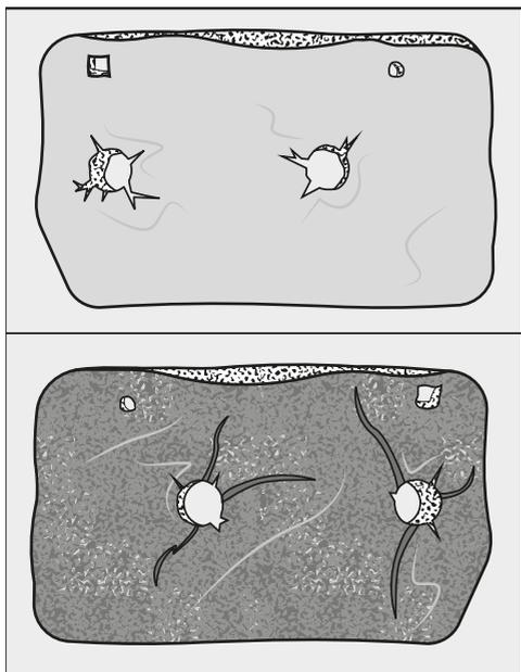
Les peluches pénètrent dans l'échangeur thermique par les fissures et déchirures, causant alors une obstruction.
