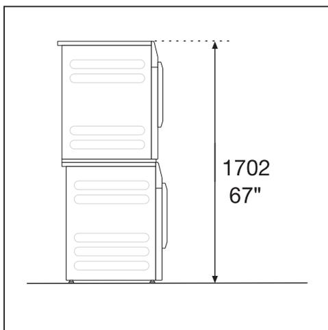
Un kit de superposition\* est requis. Il doit être installé par un technicien agréé du Service technique Miele.
