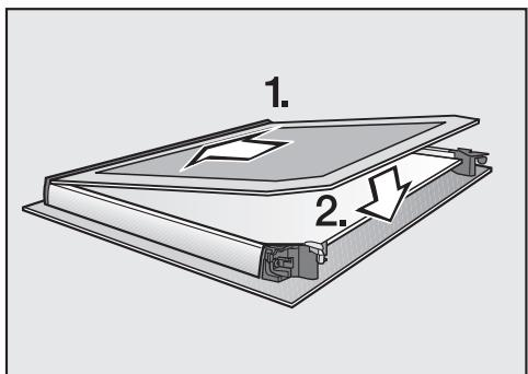
■ Notranje steklo vrat potisnite z mat potiskano stranjo navzdol v plastično letvijo in ga namestite med aretirna mehanizma.
