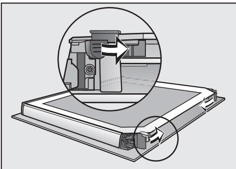
■ Aretirna mehanizma za stekla v vratih zaprite, tako da ju obrnete navznoter.
