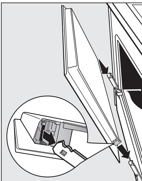
■ Vrata primite ob straneh in jih nataknite na držali tečajev. Pazite, da se pri tem ne zataknejo.
