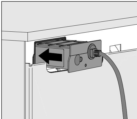
■ Zasuňte komunikačný modul do šachty. Lahkým zatlačením modul zaklapne vo svojej koncovej polohe.
