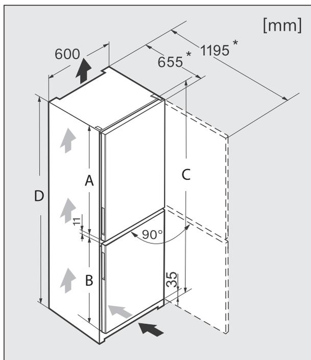
\* Medida sin soporte distanciador de pared montado. En caso de utilizar los soportes suministrados, la profundidad del aparato aumenta aprox. 35 mm.
