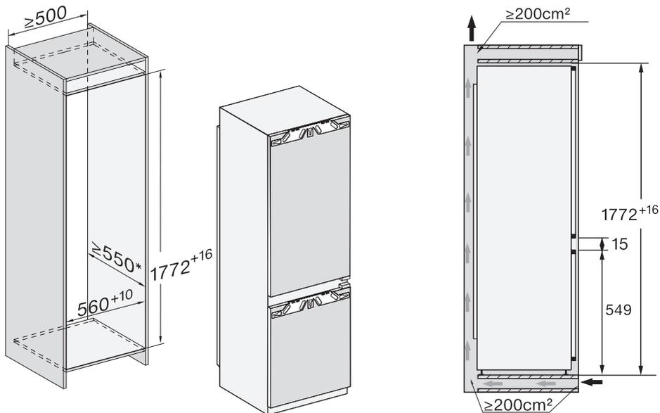
\* La consommation énergétique déclarée a été déterminée à partir d'une profondeur de niche de 560 mm. Avec une profondeur de niche de 550 mm, l'appareil de froid fonctionne parfaitement mais consomme légèrement plus d'énergie.
