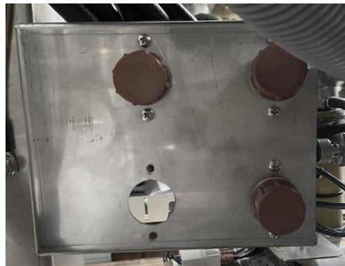
Nepřítomnost horké nebo demineralizované vody musí být nastavena v nastavení zařízení: v tomto případě zařízení provede automaticky naplnění studenou vodou místo nepřipojeného typu vody. V takovém případě není třeba montovat nepoužité vodní hadice.
