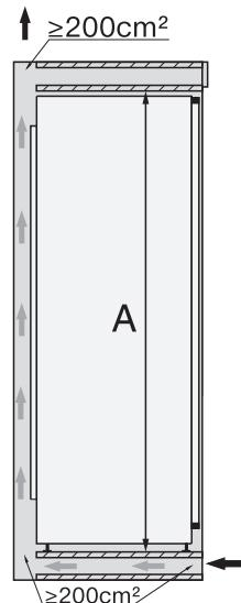
\* Deklarisana potrošnja energije je dobijena na osnovu dubine ugradnog elementa od 560 mm. Rashladni uređaj kompletno funkcioniše kada je dubina ugradnog elementa 550 mm, ali ima neznatno veću potrošnju energije.
