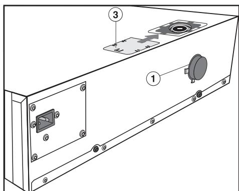
■ 将运输装置 ①固定在真空机后面。
