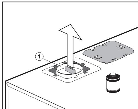
■ 将红色运输装置 ①拉出，如使用通用工具钳。
