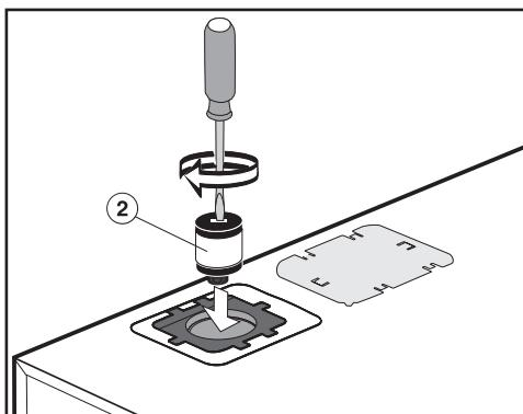
■ 用螺丝刀将空气过滤器 ②拧到真空泵上。
