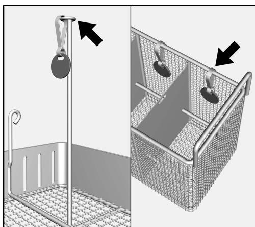
Coloque uma etiqueta de cada cor nos apoios dos utensílios e uma etiqueta nos compartimentos do cesto de peças pequenas.
