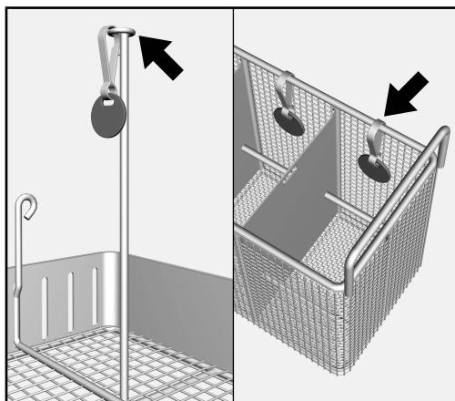
Pripevnite po jednom štítku z každej farby k prídržným krúžkom a jeden štítok k priečadkám koša na drobné diely.
