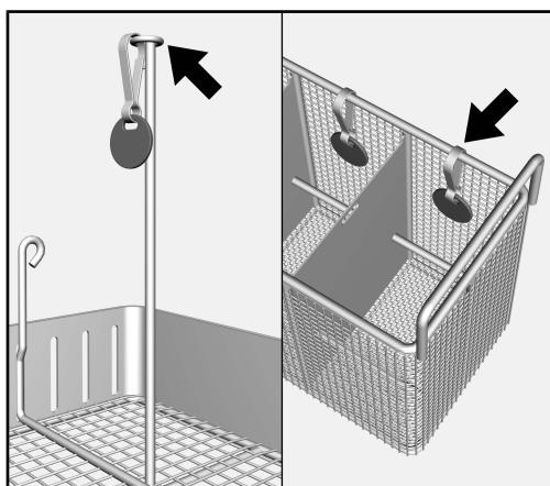
Fäst vardera en skylt av varje färg på diskgodssens hållare och ett på facken för korgarna med små delar.
