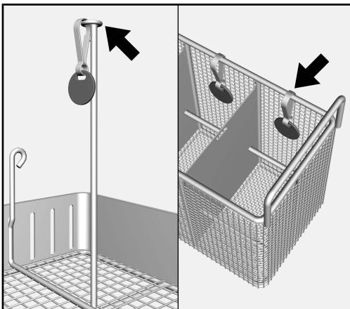
Зафиксируйте бирку одного цвета на креплении для обрабатываемого материала и бирку такого же цвета на отсеке корзины для мелких деталей.
