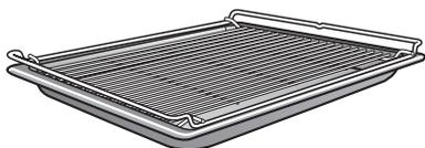
Se utilizar o tabuleiro universal com a grelha colocada em cima, encaixe o tabuleiro universal entre os guias de um nível e a grelha automaticamente acima.
