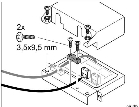
Après avoir installé tous les composants, effectuez un test de sécurité électrique conformément aux réglementations locales (par ex. VDE 0701-1).
