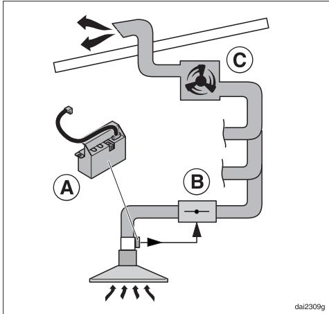
Styreelektronikkens **(A)** potentialfrie kontakt kan fx anvendes til en emhætte i serien ...EXT/EXTA, der skal tilsluttes til et fælles aftrækssystem. Kontakten kan anvendes til at betjene en elektrisk styret ventil **(B)**, der tilkobles før det fælles aftrækssystem.
