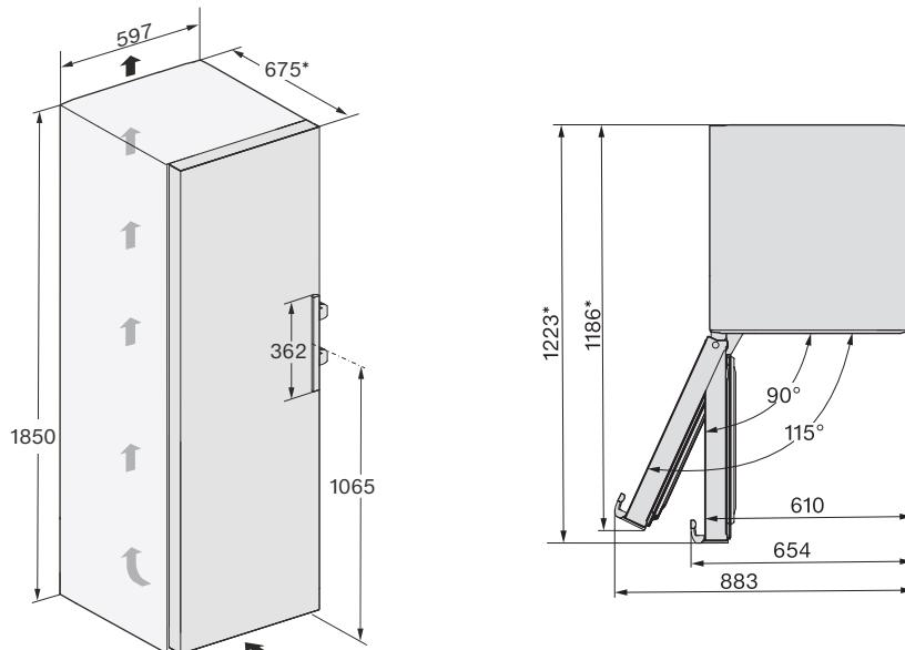
\* Dimenzije bez montiranih zidnih odstojnika. Ukoliko se koriste zidni odstojnici, povećava se dubina uređaja za 15 mm.
