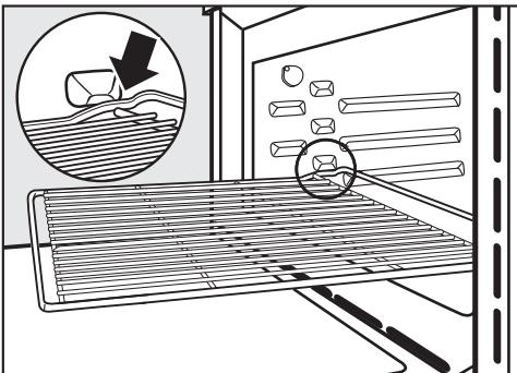
■ Čim rešetka prilikom izvlačenja udari sa zaštitom od izvlačenja, podignite napred malo rešetku.
