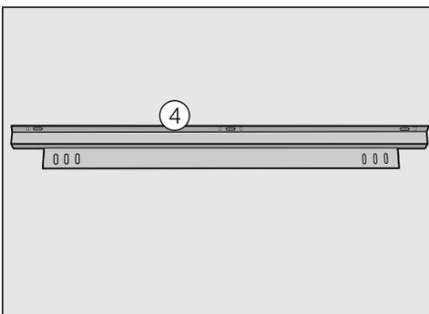
Um die Ausgleichsblende zu befestigen, benötigen Sie den Befestigungswinkel ④. Dieser ist beim Miele Kundendienst oder im Fachhandel erhältlich. Der Befestigungswinkel wird auf dem Weinschrank montiert:
