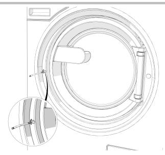
■ Drehen Sie das Entriegelungselement mit Innensechskant mit einem Torxschlüssel T 40 zwei volle Umdrehungen entgegen dem Uhrzeigersinn (links).
