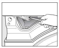
■ Entfernen Sie mit Hilfe einer Flaschenbürste Waschmittelreste und Kalkablagerungen von den Einspüldüsen des Waschmittel-Einspülkastens.
