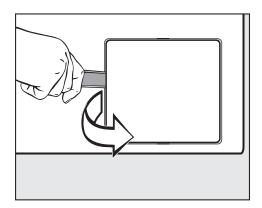
■ Öffnen Sie die Klappe zum Ablaufsystem.
