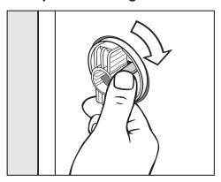
■ Lösen Sie den Rasthaken und drehen Sie die linke Transportstange mit dem Uhrzeigersinn um 90°.
