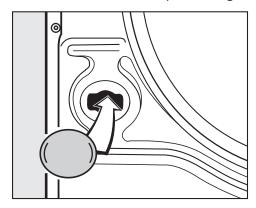
■ Verschließen Sie die Löcher mit den beiliegenden Stopfen.
