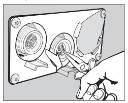
■ Ziehen Sie das Sieb mit einer Spitzzange am Steg heraus und reinigen Sie es. Der Wiedereinbau erfolgt in umgekehrter Reihenfolge.
