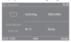
Nach Ablauf der Startvorwahlzeit oder sofort nach dem Start wird die Programmdauer im Display angezeigt. Zusätzlich wird der Programmablauf im Display angezeigt.
