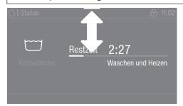
Wenn am oberen Bildschirmrand in der Mitte des Displays ein orangener Balken erscheint, können Sie sich das Pull-down-Menü anzeigen lassen. Berühren Sie den Balken und ziehen Sie den Finger auf dem Display nach unten.
