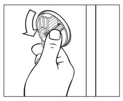
■ Lösen Sie den Rasthaken und drehen Sie die rechte Transportstange gegen den Uhrzeigersinn um 90°.
