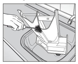
■ Reinigen Sie mit warmem Wasser und einer Bürste den Weichspülkanal.
