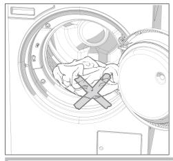
Achten Sie darauf, dass keine Wäschestücke zwischen Fülltür und Einfüllöffnung eingeklemmt werden.
