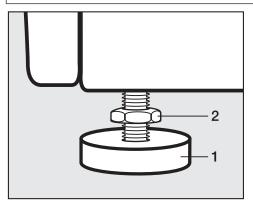
■ Drehen Sie die Kontermutter (2) mit dem beigelegten Maulschlüssel im Uhrzeigersinn los. Schrauben Sie die Kontermutter (2) zusammen mit dem Fuß (1) heraus.
