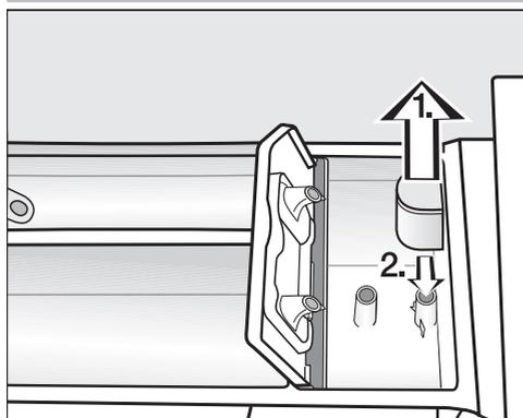
1. Retirez le tube d'aspiration de son logement ☼ et nettoyez-le à l'eau chaude. Nettoyez également le tube sur lequel le siphon est fixé.
