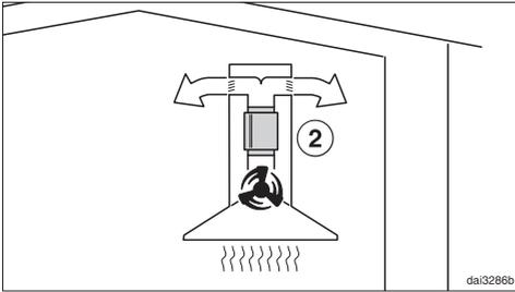
No modo de circulação de ar, o silenciador é posicionado entre o canhão de saída de ar e o desvio de direção ②. Verifique o espaço de montagem.
