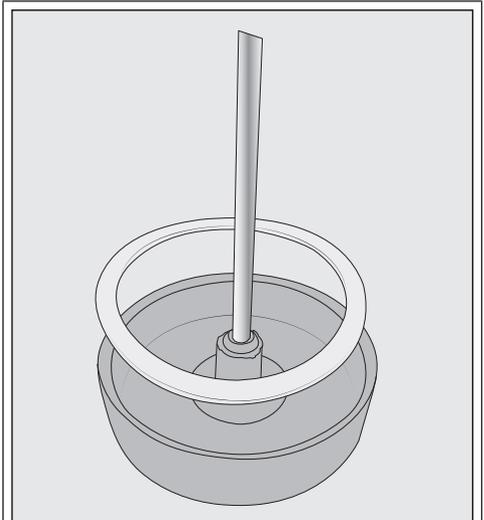
Bei Bedarf können Sie das Verbindungsstück und den Dichtring aus dem Deckel des Milchbehälters entnehmen. Wenn Sie das Edelstahlrohr entnommen haben, lässt sich das Verbindungsstück leicht von der Deckelinnenseite herausdrücken.
