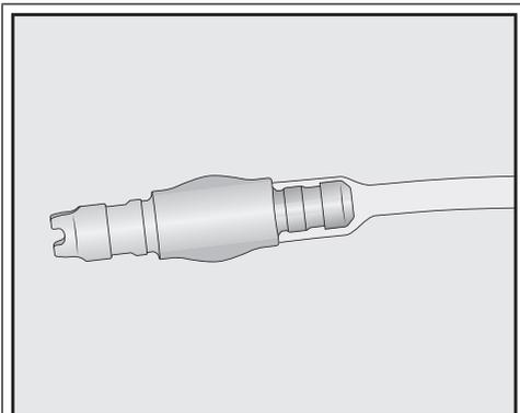
Falls Sie das Anschlussstück von der Milchleitung gelöst haben: Achten Sie beim Zusammensetzen darauf, dass die kleinere, dünnere Seite des Anschlussstücks in den Schlauch geschoben wird.
