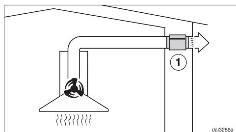
Bei Abluftbetrieb dämpft der Schalldämpfer sowohl Gebläsegeräusche nach aussen als auch Aussengeräusche, die über die Abluftleitung in die Küche dringen (z. B. Strassenlärm). Dazu wird der Schalldämpfer möglichst nah vor dem Abluftaustritt (1) positioniert.
