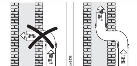
Wenn die Abluft in einen Abluftkamin geführt wird, muss der Einführungsstutzen in Strömungsrichtung gelenkt werden.
