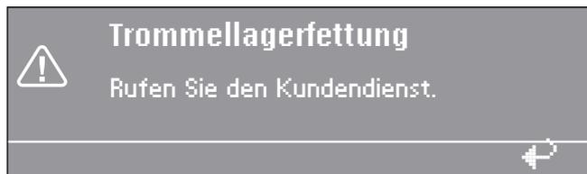
Mit der Taste
