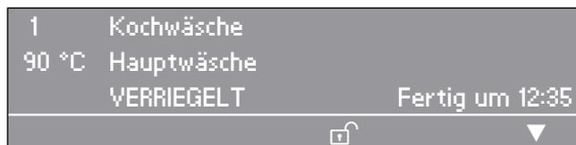
Das Display zeigt diesen verriegelten Zustand an, wenn versucht wird, mit Betätigung der Taste
