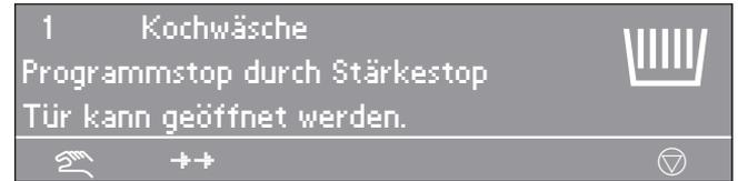
Taste "START" betätigen und das Programm wird fortgesetzt.
