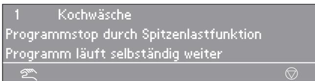
Nach Ende der Spitzenlastfunktion wird das Programm automatisch wie bisher fortgesetzt.
