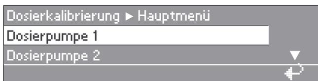
Anwahlmöglichkeiten: Dosierpumpe 1 bis 13
