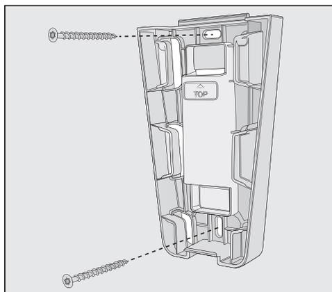
■ Pričvrstite montažnu ploču na zid.
