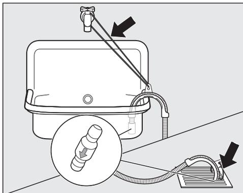
⚠ Risque de dommages dus à l'écoulement d'eau. Si l'extrémité du tuyau se détache, l'eau qui s'écoule peut provoquer des dommages. Sécurisez le tuyau d'évacuation contre tout risque de glissement (par ex. en l'attachant).
