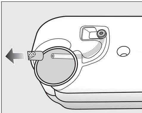
Ne tirez pas trop fort sur le tuyau : Il ne doit pas se détacher.
