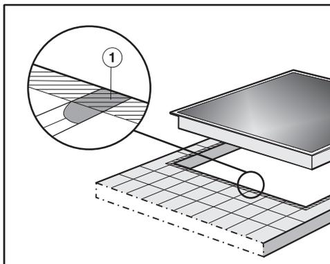
Les joints ① et la zone rayée sous la surface d'appui du plan de cuisson doivent être lisses et plans pour que le plan de cuisson se pose uniformément et que le joint en dessous du bord de la partie supérieure de l'appareil fournisse une étanchéité suffisante.
