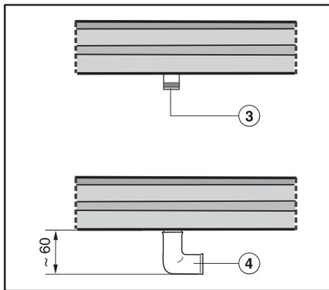
③ Raccordement au gaz R 1/2" - ISO 7-1 (DIN EN 10226)
