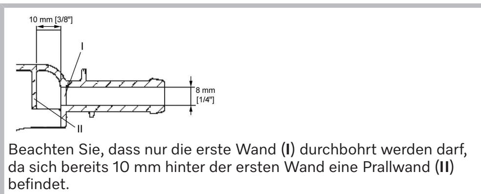
Beachten Sie, dass nur die erste Wand (I) durchbohrt werden darf, da sich bereits 10 mm hinter der ersten Wand eine Prallwand (II) befindet.
