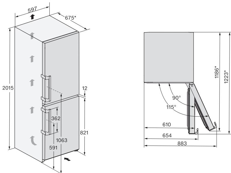
\* Διάσταση χωρίς εγκατεστημένους αποστάτες τοίχου. Αν χρησιμοποιηθούν οι συνοδευτικοί αποστάτες τοίχου, το πάχος της συσκευής αυξάνεται κατά 15 mm.
