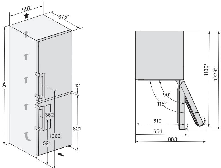
\* Dimenzija bez postavljenog dodatka za odmak od zida. Ako se koriste priloženi dodaci za odmak od zida, dubina za ugradnju uređaja povećava se za 15 mm.
