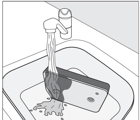
**Tip:** Damit sich vorhandene Rückstände auf der Oberfläche schneller lösen, lassen Sie einen Wasserstrahl senkrecht über die Vorderseite des Sockelfilters laufen.
