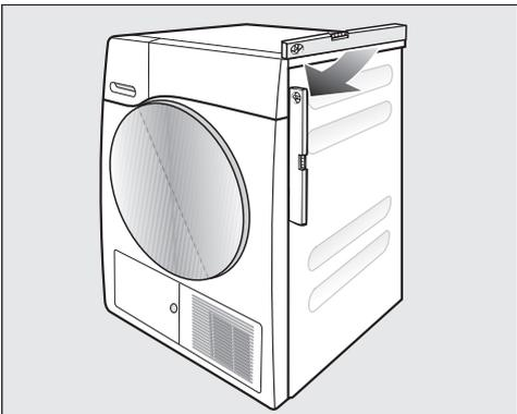
Für einen einwandfreien Betrieb muss der Trockner lotrecht ausgerichtet werden. Bodenunebenheiten können durch die Schraubfüße des Trockners ausgeglichen werden.
