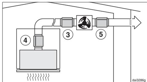
Lors du fonctionnement avec un ventilateur externe, les bruits du ventilateur peuvent être réduits vers l'extérieur et dans la cuisine.
