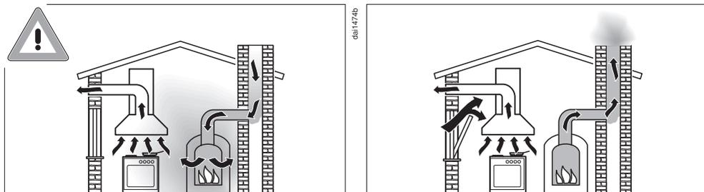
**⚠** Pericolo di intossicazione a causa dei gas combustibili. Se la cappa viene messa in funzione mentre è attivo un fuoco (fiamma) alimentato con aria ambiente, è necessario adottare delle precauzioni.
