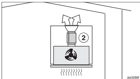
In caso di funzionamento a riciclo d'aria, l'insonorizzatore va installato tra il manico di sfiato e la griglia di sfiato ②. Controllare lo spazio per l'installazione.
