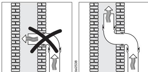
Si l'air est évacué dans une cheminée d'évacuation, le manchon d'entrée doit être orienté dans le sens de l'écoulement.
