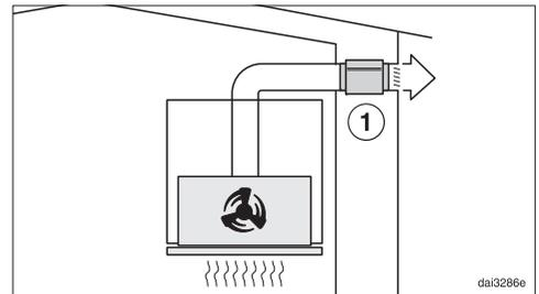
En mode évacuation, le réducteur de bruit insonorise aussi bien les bruits du ventilateur vers l'extérieur que les bruits extérieurs qui parviennent par la conduite d'évacuation (par ex. bruits des voitures). Aussi le réducteur de bruit doit être posé le plus près possible de la sortie d'évacuation d'air ①.
