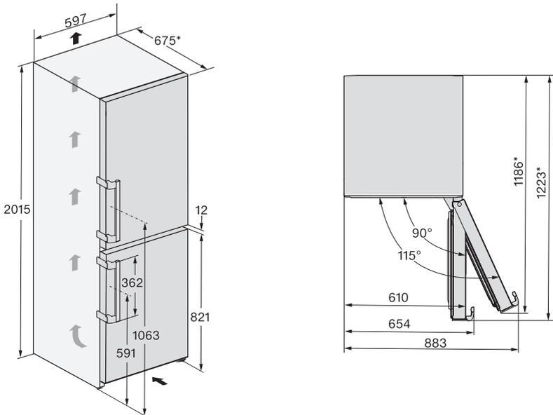
\* Medida sin soporte distanciador de pared montado. En caso de utilizar los soportes suministrados, la profundidad del aparato aumenta aprox. 15 mm.
