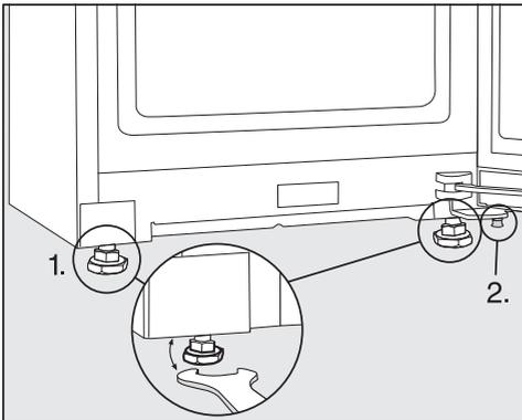
■ Utilice un nivel de burbuja y la llave de boca adjunta para nivelar el aparato, y apoye la puerta.
