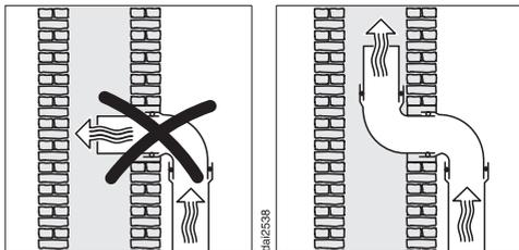
Si la salida de aire se conduce a una chimenea de salida, el manguito acodado de la conducción deberá estar orientado en el sentido de la corriente.
