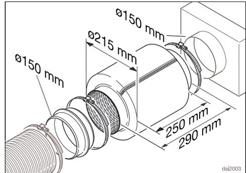
En la conducción de salida de aire se puede colocar un silenciador (accesorios especiales).
