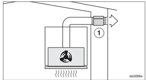
El silenciador amortigua tanto los ruidos del ventilador hacia fuera como los ruidos exteriores que entran en la cocina a través de la conducción de salida de aire (p. ej. el ruido de la calle). Para ello, el silenciador se coloca lo más cerca posible de la salida de aire ①.
