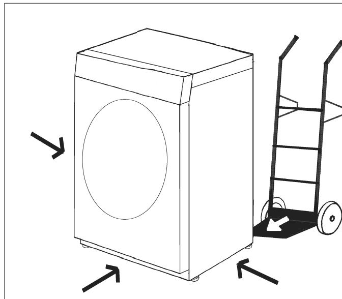
Transportar la secadora con un medio de transporte adecuado (p. ej. una carretilla) hasta el lugar de emplazamiento.
