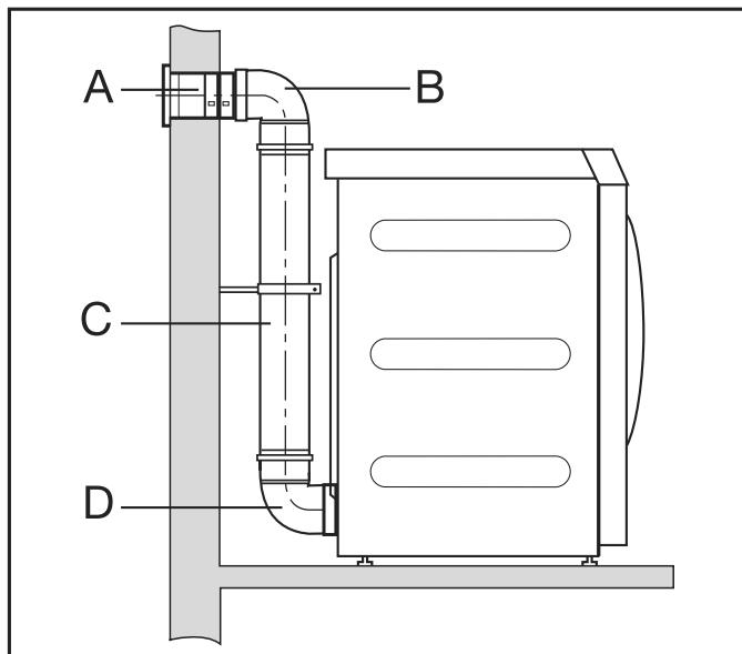
**A Tubo de parede, com grelha**
