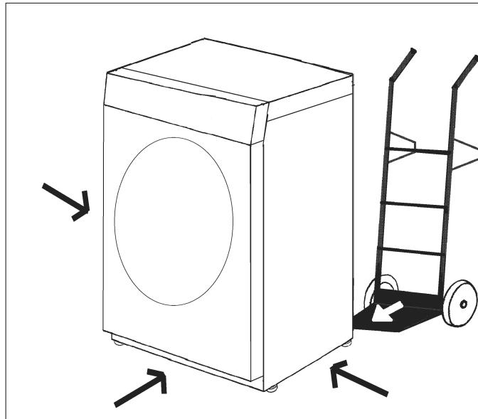
Transporte o secador com uma ajuda de transporte adequada (p. ex. carrinho) até ao local de instalação.
