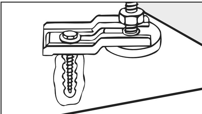
Es imprescindible fijar la secadora por las patas con bridas de sujeción (accesorio).
