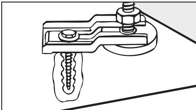
Fixe o secador aos pés enroscáveis com patilhas de fixação (acessórios).
