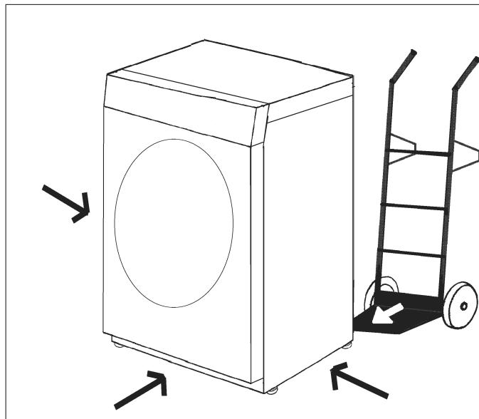
A szárítógépet egy megfelelő szállítási segédeszközzel (pl. kézikocsi-val) szállítsa a felállítási helyre.
