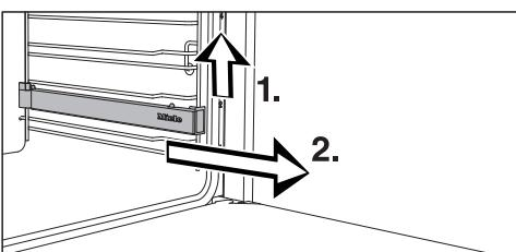
■ Soulevez le rail coulissant FlexiClips par l'avant (1.) et sortez-le en le faisant glisser le long de la barre (2.).
