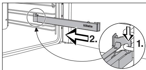
■ Insérez le rail coulissant par l'avant, sur la barre inférieure d'un niveau de cuisson (1.) et faites-le glisser le long de la barre dans l'enceinte de cuisson (2.).
