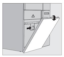
Der Hauptschalter für die Trennung des Reinigungsautomaten vom elektrischen Netz liegt hinter der Serviceklappe.
