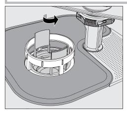
■ Drehen Sie den Mikrofeinfilter in Pfeilrichtung los und nehmen Sie ihn zusammen mit dem Grobsieb heraus.
