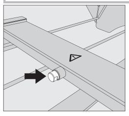
■ Tauschen Sie für die Spüldruckmessung die Blindschraube gegen einen Luer-Lock Adapter aus.
