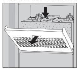
■ Lösen Sie das Filtergitter und klappen Sie es nach unten auf.
