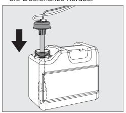
■ Stecken Sie die Dosierlanze in die Öffnung des gefüllten Behälters.
