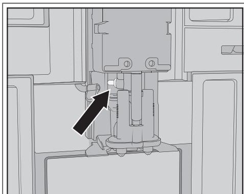
**No** retirar la pieza de conexión del conducto para la leche.
