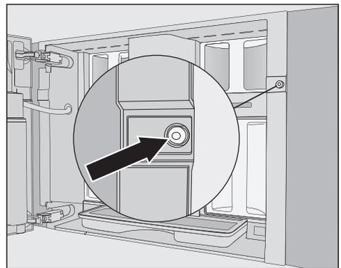
En el orificio del tornillo hay una perilla de silicona roja que sujeta la puerta del aparato para evitar que el aparato sufra daños durante el transporte.
