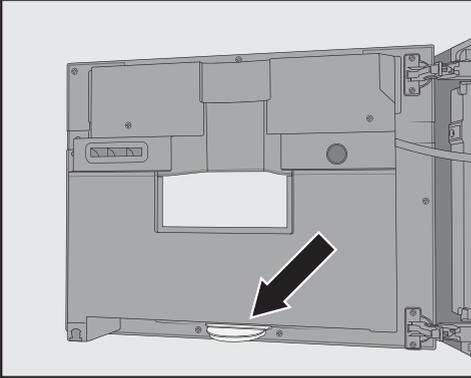
En la parte inferior del interior de la puerta se encuentra la bandeja colectora. Limpiar regularmente la bandeja de goteo.
