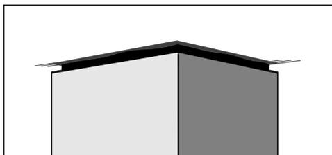
Le **cadre d'espace** peut être installé entre la cheminée et le plafond. Cela crée une ombre qui donne l'illusion d'un écart entre le plafond et la cheminée. Cela sera utile si le plafond n'est pas de niveau ou est inégal. La hotte est alignée verticalement avec les dispositifs d'espace fournis. Les irrégularités visuelles entre la cheminée et le plafond seront alors dissimulées par l'ombre.
