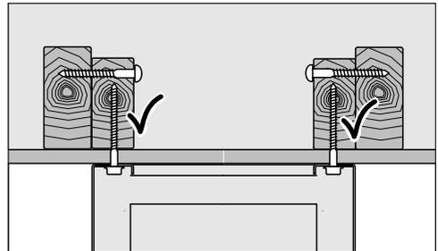
La hotte doit être fixée à un cadre de structure rigide entièrement soutenu par les solives du plafond ou directement fixée à celles-ci. Ne fixez pas la plaque directement au plafond avec des ancrages, des boulons à ailettes, etc.
