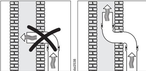
Si l'air vicié doit être dirigé dans une gaine d'air, le conduit doit être aligné dans le sens du flux du tuyau.
