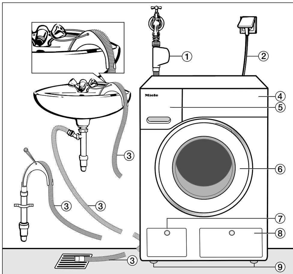
① Tuyau d'arrivée d'eau avec système AquaSécurité
