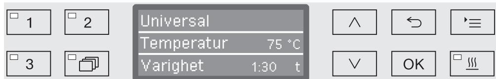
LED-lyset i det valgte tastefeltet starter å lyse og i displayet vises det aktuelle programmet. I tillegg starter LED-lyset i tastefeltet *Start/Stop* å blinke.
