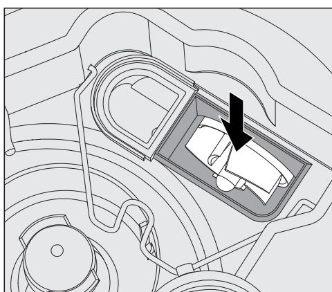
Under tilbakeslagsventilen sitter vingehjulet til avløpspumpen (pil).
