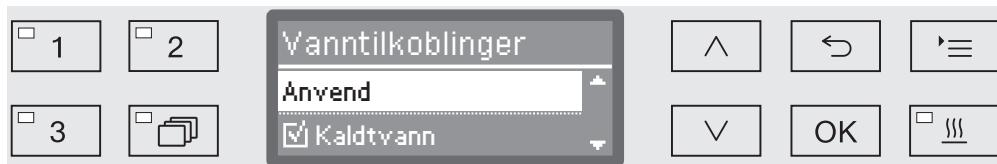
Innstillingen av vanntilkoblingene skjer via flere valg. I displayet er det en boks  foran alle vanntilkoblingene. Er vanntilkoblingen aktivert, er boksen huket av . Ved valg av vanntilkoblingene kan du aktivere hhv. deaktivere disse.
