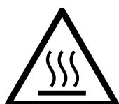
Advarsel! Svært varme overflater:
