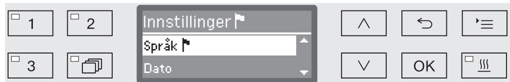
Ved hjelp av piltastene  $\wedge$  og  $\vee$  på betjeningspanelet, kan du navigere gjennom menyen.
