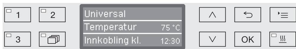
I displayet vises det valgte programmet med innstilt starttid. Er den automatiske utkoblingstiden aktivert (se kapittel «Flere innstillinger/Utkobling etter»), kobler rengjøringsautomaten seg ut fra innstilt tid til programstart.
