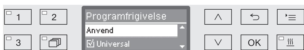
Du velger program fra en lang liste. I displayet står det en boks  foran alle programmene. Hvis programmet er frigitt, ser du en hake . Sperrede programmer er markert med en tom boks.
