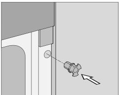
■ Insérez l'aide au montage dans le trou du cadre frontal.
