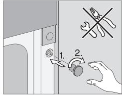
■ Vissez à la main l'écrou moleté sur le boulon pour fixer le four à vapeur à l'armoire.
