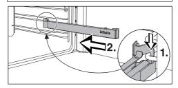
Accrochez le rail coulissant télescopique FlexiClip à l'avant du rail inférieur d'un niveau de cuisson (1.), puis poussez-le le long du rail dans la cavité du four (2.).
