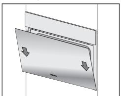
Tenez fermement les deux côtés de la porte et ajustez-la soigneusement dans les pattes de fixation des charnières.
