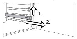
■ Retirez le rail coulissant télescopique FlexiClip en le soulevant à l'avant (1.) et en le tirant vers vous le long de la glissière du niveau de cuisson pour le sortir (2.).
