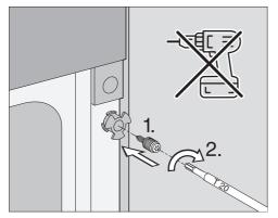
■ Insérez le boulon dans l'aide au montage et serrez-le dans le corps de l'armoire. **N'utilisez pas** de visseuse sans fil.
