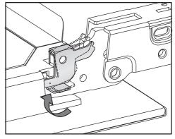
■ Pour bloquer les étriers de verrouillage, redressez-les au maximum en position horizontale sur les deux charnières de porte.
