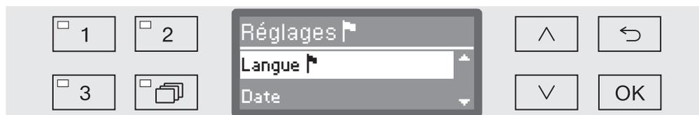
Les flèches de navigation  $\wedge$  et  $\vee$  du panneau de commande permettent de naviguer dans le menu.
