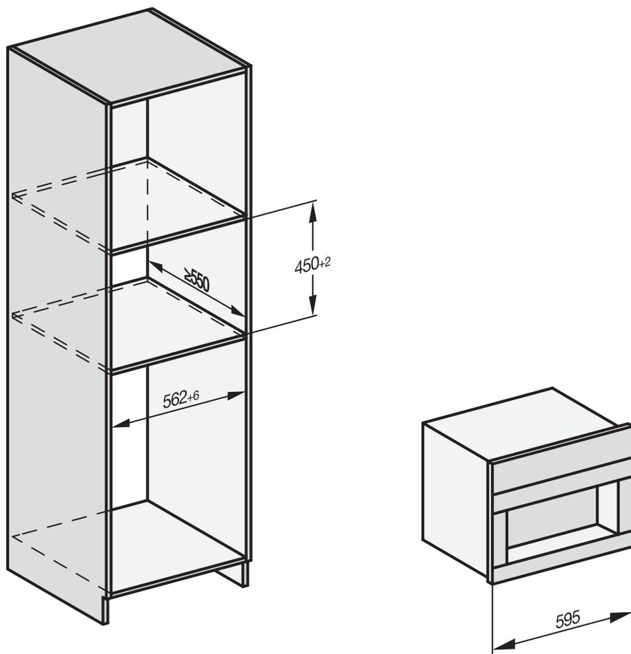
機器は、ミーレの他のビルトイン機器と組み合わせることができます。コーヒーマシンを別の機器の上に設置する場合は、間に十分な幅のある中間棚を設ける必要があります。グルメビルトインウォーマー/ビルトイン真空ドローと組み合わせる場合は、その間に中間棚は必要ありません。
