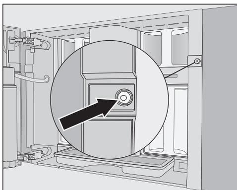
ネジ穴の内側にある赤色のシリコンプラグは、輸送中に機器のドアを固定し、輸送中の損傷を防ぐためのものです。
