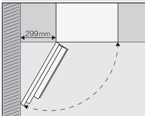
**ヒント:** 壁とコーヒーマシンの間に299 mm以上の隙間があれば、機器のドアを大きく開けることができ、快適に使用することができます。例えば、左側の豆コンテナを取り外す方が簡単です。
